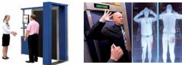
Equipamento que utiliza radiação ionizante para escanear corpos humanos nas inspeções de segurança, em presídios, aeroportos e órgãos públicos. Quanto melhor a resolução da imagem, maior o nível de RX que o *bodyscan* emite. A operação do equipamento só pode ser feita por profissionais legalmente habilitados pelo Sistema CONTER/CRTRs.
